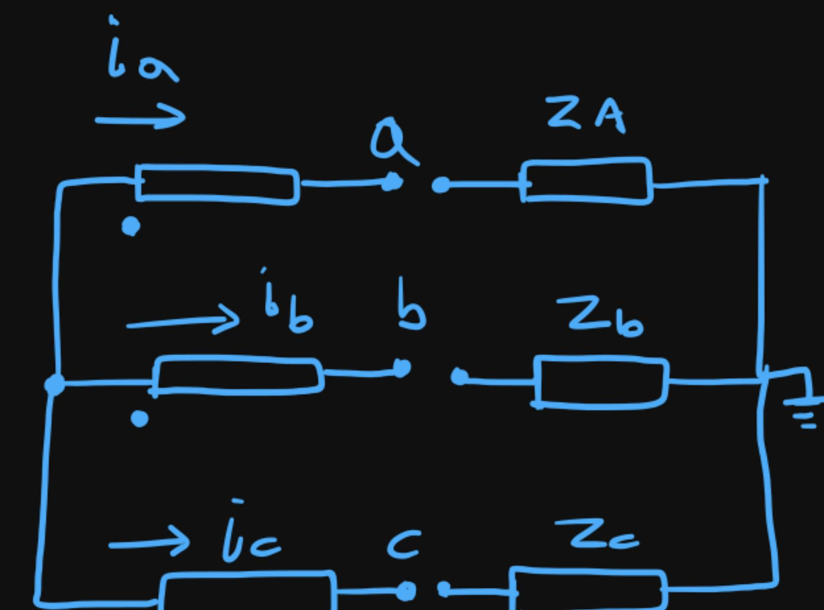
2. Ένας ΜΣ Dyn11, 20/0,4kV, 1000 kVA,  $u_k=0,15\text{pu}$ , 50 Hz τροφοδοτεί τα παρακάτω φορτία στην πλευρά της χαμηλής τάσης υπό ονομαστική τάση:
